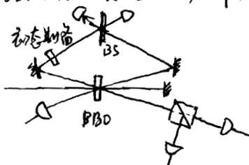
A: 脉冲光源通过BB0晶体，通过自发参量下转换产生偏振纠缠态。(type II)
