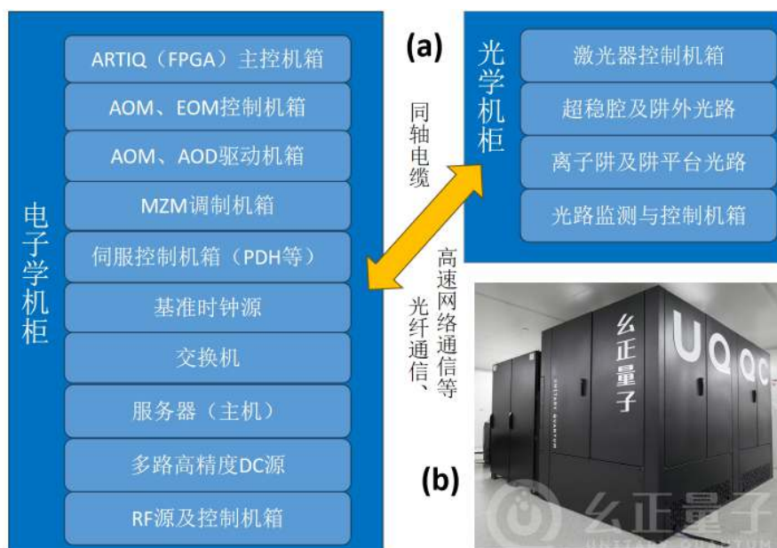
图 6.1 (a) 离子阱机柜结构图 (b) 么正量子发布的离子阱工程机柜
