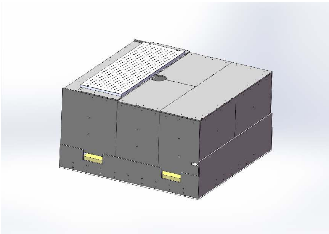
图 3.21 阱平台温度稳定亚克力罩设计图。保温罩由 5 mm 厚黑色亚克力板组成，固定在大理石台侧边的螺丝孔上，保温罩除必要的电气连接外，无其他孔洞，并用保温棉进一步密封和隔热。
