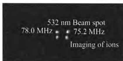
图 5.1 532 nm 激光光斑和离子的图像。图中位于上层的是 532 nm 激光光斑,位于下层的是离子。左边光斑对应的 AOD 驱动频率为 78.0 MHz,右边光斑对应的 AOD 驱动频率为 75.2 MHz。图中也可看出激光光斑的大小远小于离子间距。
