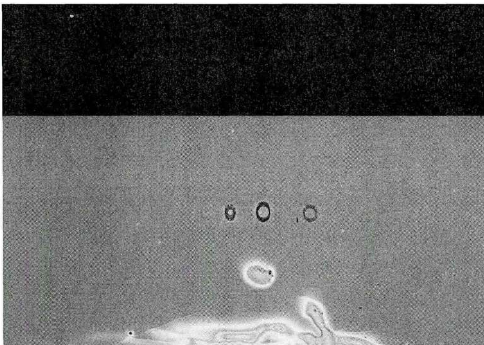
图 4.12 分别用 570, 510 和 450 nJ 的能量从左到右分别写出了直径为 10, 20 和 20 \mu\text{m} 宽的波导结构
