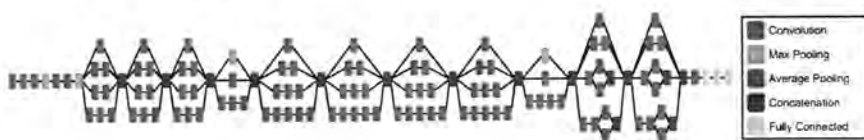
图 6.3 Adapted Inception v3 架构的卷积神经网络, 用来预测 Zernike 系数。数据从最左端输入, 从最优端流出。
