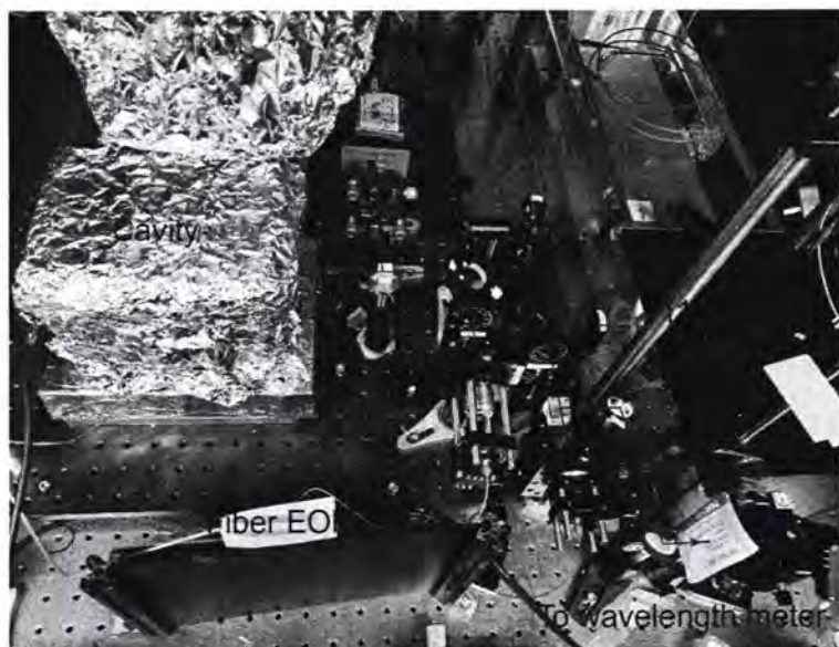
图 4.12 PDH 锁频装置图。1109 nm 光经过 PBS 后一路输入波长计监测波长，另一路耦合进光纤 EOM 后进入超稳腔。超稳腔锁频光路放置在隔震的面板上提高稳定性。腔体内部抽真空至 10^{-6} torr，外部用主动控温和被动保温（保温棉包裹）减少温度漂移带来的影响。
