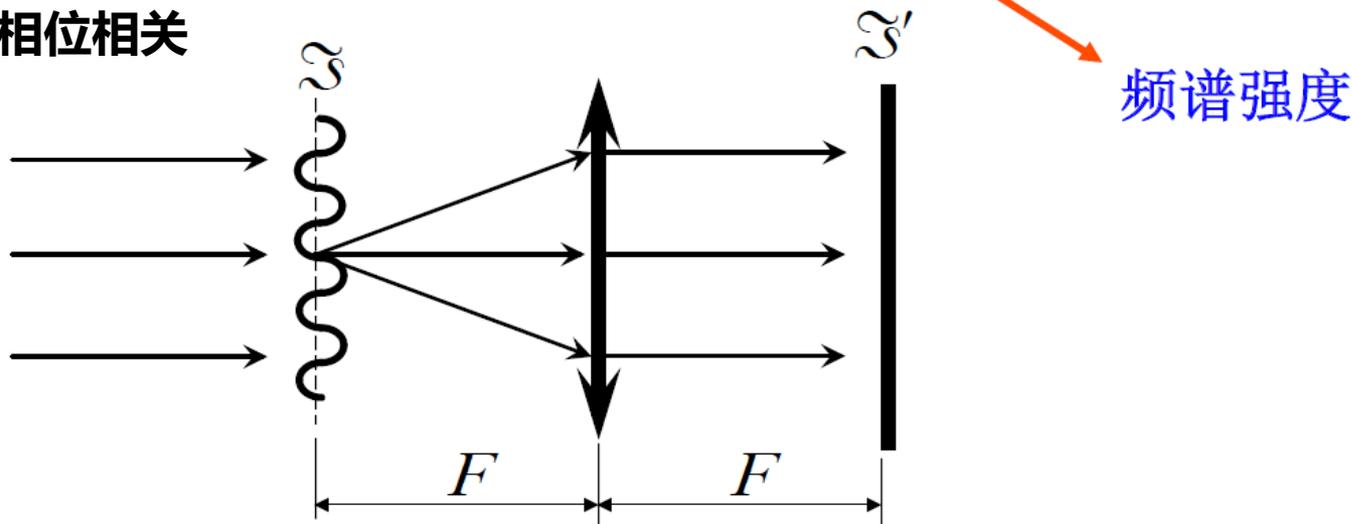
等光程光路： $\phi(x', y') = kL_0(x', y') = \text{const.}$
